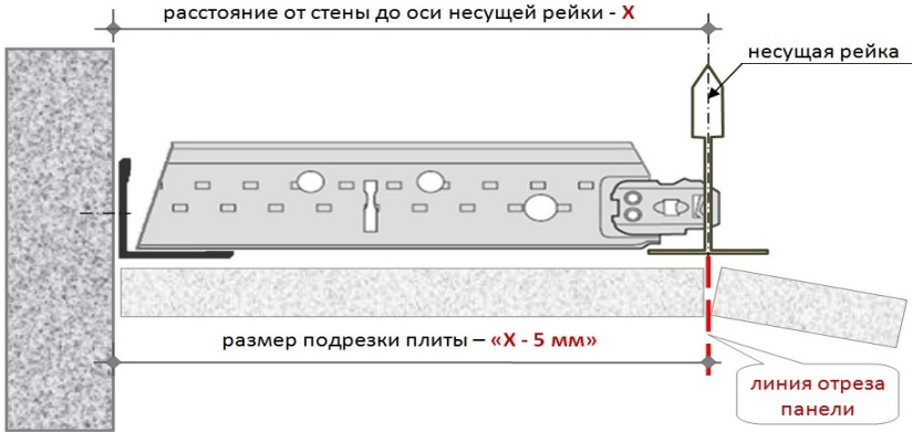
Рис. 50. Правильная обрезка панели
